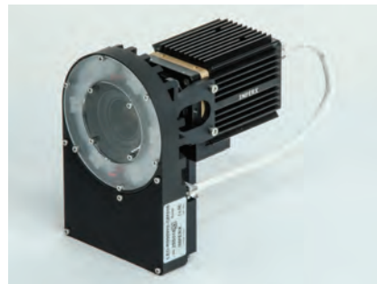
图4: Imperx公司提供LED PoE环形灯,以简化LED频闪灯的安装。在设计中,环形灯通过PoE接口驱动,可直接从相机触发。
