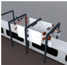
图1: PSI Technics公司的系统从多个角度捕获轨道车辆的图像。
