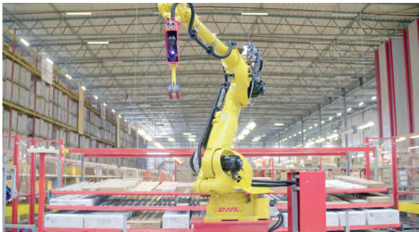
图1: Robomotive公司的系统使用安装在机器人上的Zivid 3D相机用于引导机器人的动作，并使用真空夹持器将包装盒移动到传送带上。
