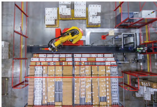
图2: 该系统用于DHL公司位于荷兰的仓库中，实现打印机墨盒箱子的搬运。
