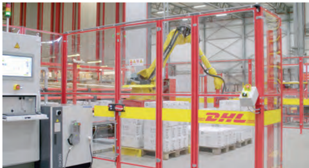
图4：在机器人单元外，操作员可以与Robomotive的系统交互，并提供有关托盘位置的说明。
