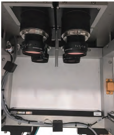
图2: 使用安装在太阳能电池上方的相机系统，该系统采用平板背光源确定电池的位置和方向；采用高轴条形光配置来检测任何母线间隙、浆料污渍和手指线的数量。
