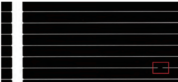
图4：为了分析每行浆料的每个像素，找出太阳能电池的间隙、厚区域和薄区域，在红色条形灯照明下对电池进行成像。然后，使用ATS StimeVision软件中的一系列Dispense工具，来分析每行浆料的每个像素。
