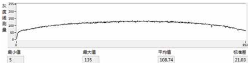
图7: 加棱镜膜后图片中心灰度值。
