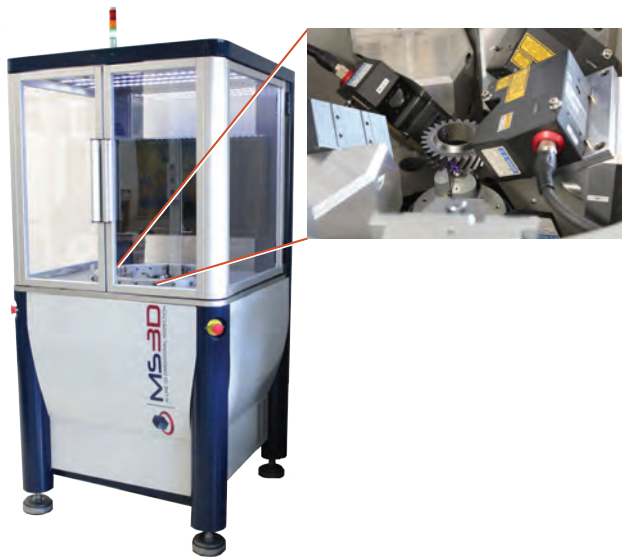
图1：新开发的齿轮检测系统使用多个3D激光三角测量传感器，能提供100%的齿轮在线检测，为齿轮箱制造商节省大量时间和金钱。
