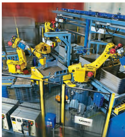
图2: 来自Sick公司的PLB机器人引导系统, 在没有操作员干预的情况下, 能让机器人从物料箱中抓取零件的操作运行50~60小时。
