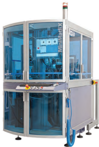
图1：为了开发一套机器视觉系统用于检查垫圈、螺钉和橡胶垫等小零件，UTPVision公司使用了一个配有三个视觉站点的旋转台。
