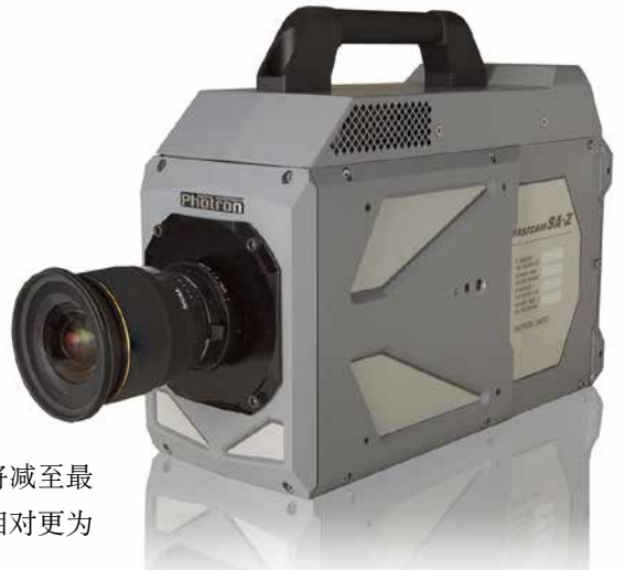
图1: Photron公司的FASTCAM SA-Z是一款12位1024×1024分辨率的高速相机，运行帧率可达20,000fps，ISO灵敏度分别为ISO 50,000（单色）和ISO 20,000（彩色）。
