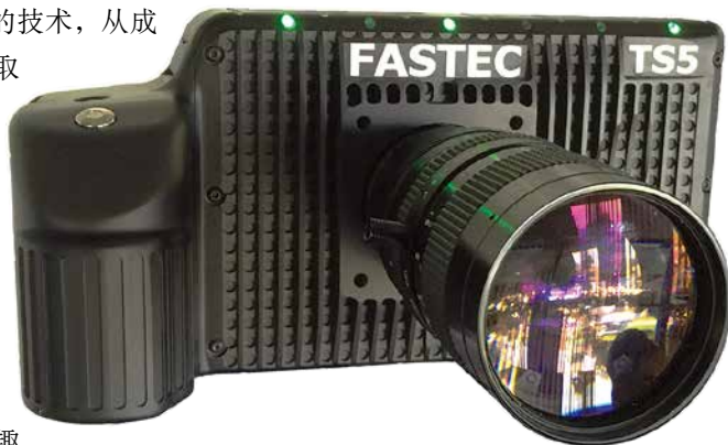
图3: Fastec Imaging公司的TS5-D高速相机, 使用2560×2048 CMOS成像器, 能以634fps的帧率拍摄全分辨率高清图, 并将图像数据存储到相机的8GB内存中。
