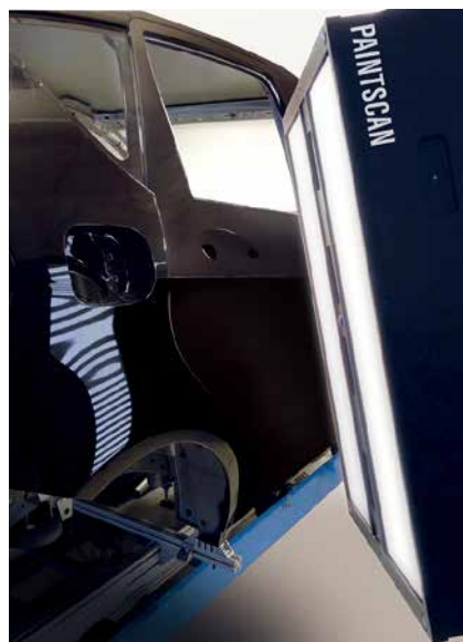
图1：最先进的处理器、高分辨率的GigE Vision相机组件和定制的LED矩阵照明，为喷漆缺陷检测提供了可靠的在线3D测量。
