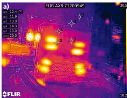
图4：为了定位和确定斑点的尺寸，对热图像进行滤镜处理，这样软件就只识别落在一定温度范围内的区域。然后，处理后的图像应该简单地包含包装上已经加注胶水的那些区域。接下来，使用斑点分析来定位斑点的位置，并计算它们的面积。
