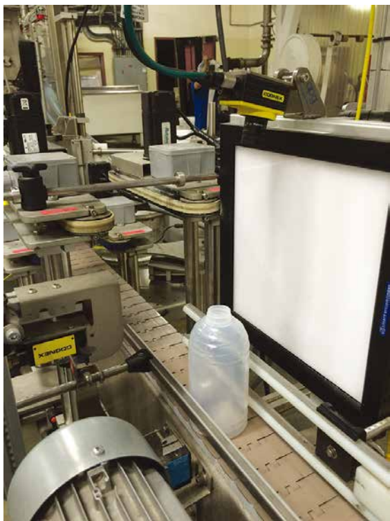
图1: 当蜂蜜瓶沿着生产线上以每分钟80个瓶子的速度移动时，为了使瓶子处于正确的朝向，ACS公司已经开发出了一套自动化视觉系统。该系统采用两台智能相机和一套照明系统，用于为瓶子提供前向和后向照明。
