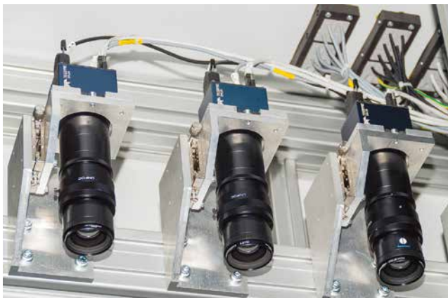
图2: 当部件移动通过系统时, 它们由安装有150mm镜头的八台线扫描相机(图中仅显示了其中三台)对其成像。相机安装在传送带上方大约1.5~2m的地方。
