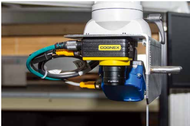
图1: 要检查每个零件上的激光标记, 首先用LED光源照亮字母数字代码, 并使用安装在传送带上方的智能相机, 捕获零件的图像。
