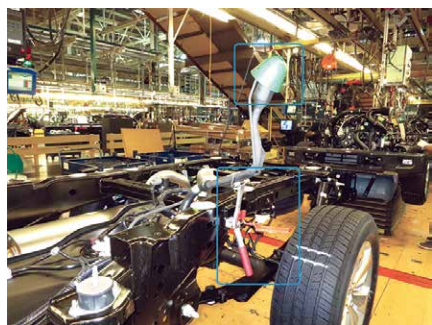
图 1a 和 b: Indicon 公司的工程师安装了一套视觉引导系统，以确保 F-150 卡车的燃油加注器被放置在正确位置，使得卡车的底床能与车架完美地装配到一起。
