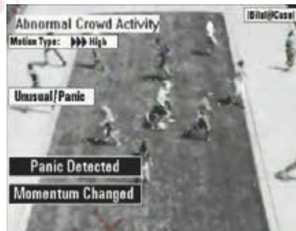
图1: 通过使用加权绝对差之和(SWAD)对当前和以前的图像执行运动计算,可以自动标记图像序列以及向保安人员发出警报。
