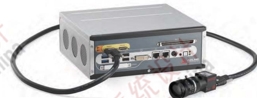
图1: 为了支持Camera Link工作, ADLINK公司的EOS-4000支持两个独立的Camera Link Base PoCL端口、85 MHz像素时钟频率、触发和编码器输入, 以及两个独立的RS-232串行通信端口。
