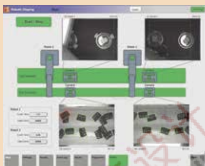
图4: ControlVisio公司的VisionServer软件作为该系统的人机界面(HMI),用于配置系统参数、监控整个卡扣装配过程。
